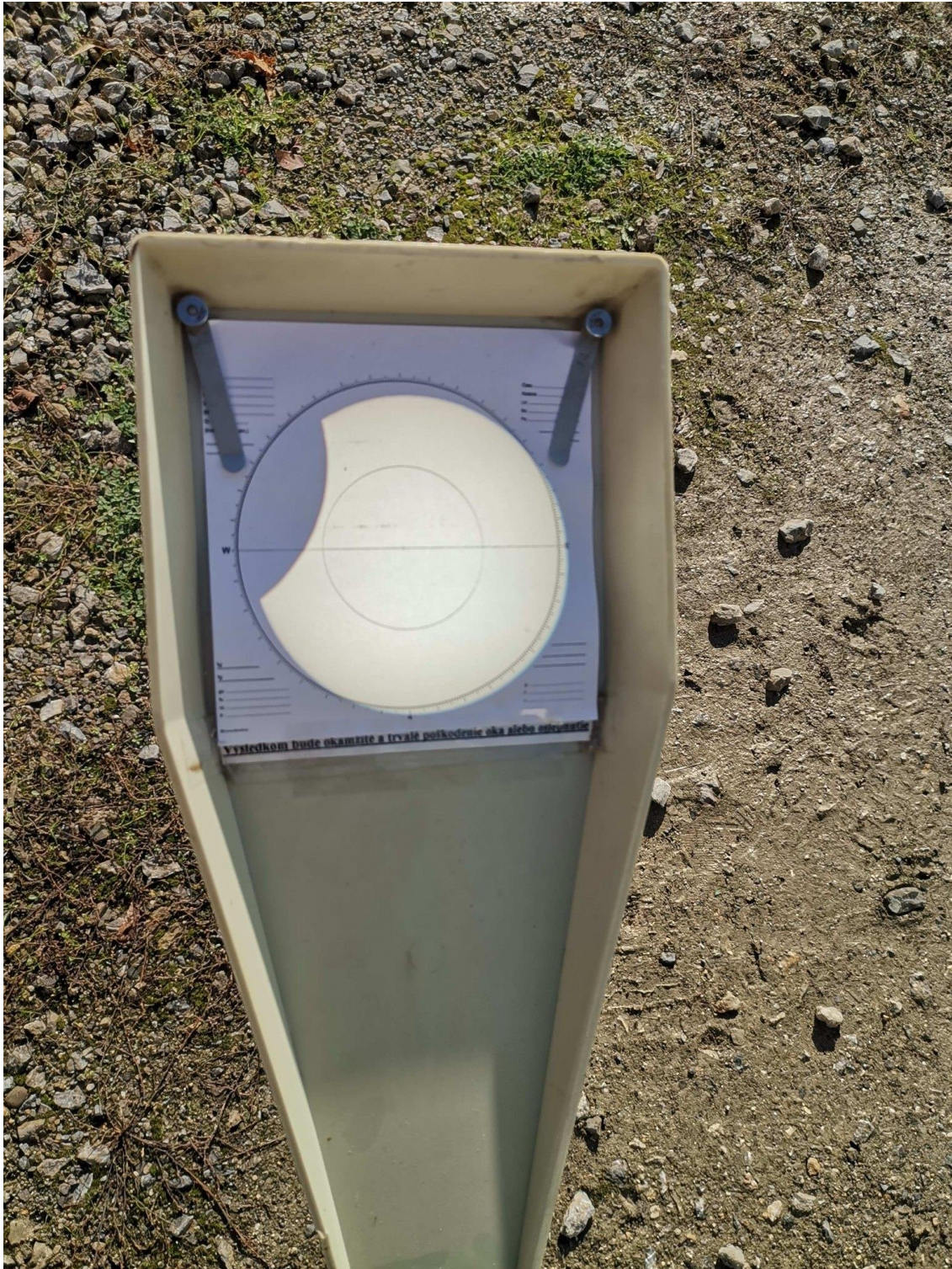
A napfogyatkozás észlelésére készült érdekes kiképzésű vetítőlapp a deklinációs tengely végére felfogva
