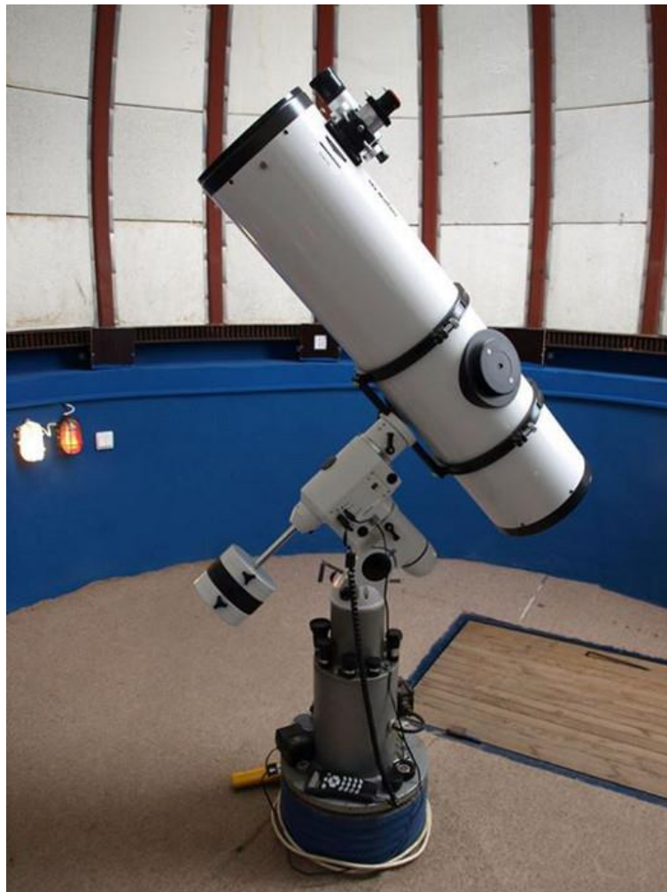
A felújított kupolába elhelyezett 254/1200 mm-es Newton távcső a SW EQ6 GoTo mechanikán
